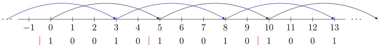
*Remarque* : on utilisera la convention que l'entier 0 s'envoie sur le premier booléen positionné à 1 du masque de longueur un entier  $p$  donné, et par concaténation (i.e. par translation du masque), chaque nombre divisible par  $p$  s'enverra sur une occurrence de ce booléen 1 en position initiale dans une copie du masque de base. Les petits traits rouges verticaux sont destinés à faciliter la lecture des concaténations de mots binaires.
