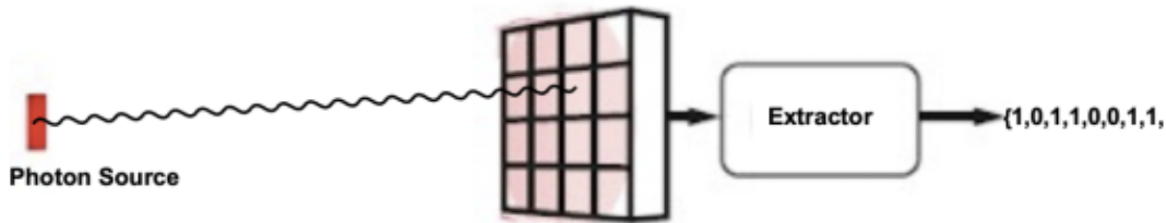
Figure 2 : Générateur quantique de nombres aléatoires
