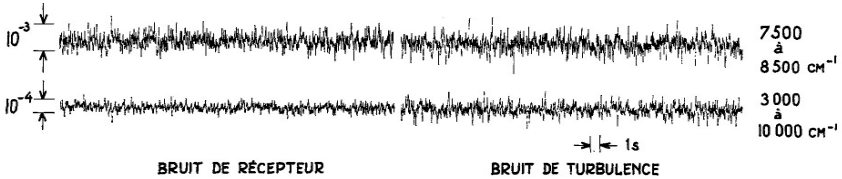
FIG. 12. — Bruit de récepteur seul (cellules dans l'obscurité), et bruit de turbulence avec modulation interne. Faisceau de Vénus. Constante de temps 0,1 s.
