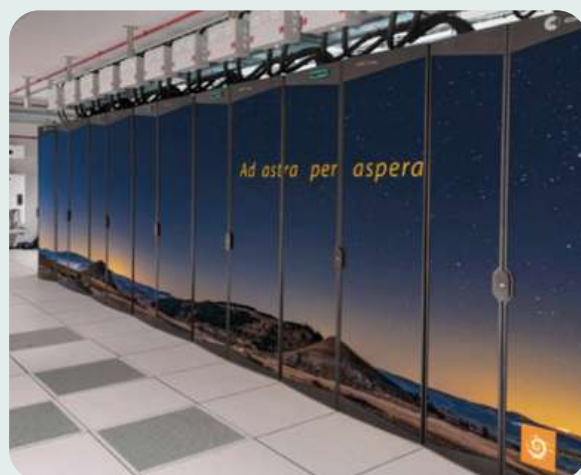
CINES 2023 : ADASTRA 75 pétaflops (HPE Cray AMD) # 10 Top 500 Juin 2022 # 3 Green 500 2022 2023 (58,2 GF/W). 2 partitions CPU et GPU. Du HPC à l'IA !
